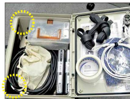
カメラ、バッテリー、クリアケースを収納する。収納BOXの向かって左側の隅には蓋のハンドル可動域を確保するためスペースを設けるようにする(黄線で囲った部分)
